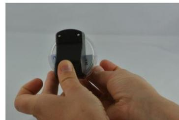
Abbildung 1: KoKo 2 auf den  $\mu$ flow skyW-2 aufsetzen
